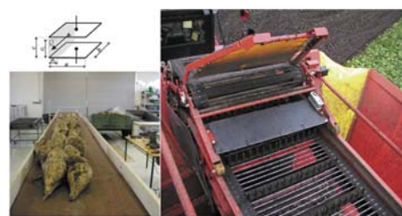
Bezkontaktní kapacitní čidlo při laboratorním a provozním měření
