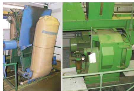
vlevo - vstup chmelových hlávek do granulační linky, vpravo - granulátor
