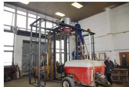
Obr. 5: Stavba rosiče pro nízké konstrukce
